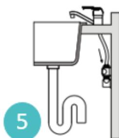
5 Installieren Sie das Abzweigstück (T-Stück) am Eckventil und schließen den KW-Schlauch vom bestehenden Hahn an.
