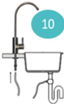
Installieren Sie den Ausgang "reines" Wasser und den Ausgang "naturelles" Wasser mit dem Zusatzhahn (weißer & blauer Schlauch)
