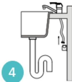
4 Eckventil absperrn und den Kaltwasserschlauch vom Eckventil abschrauben.
