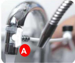
**1. Umlenkperlator (A):** Bei dieser einfachsten Methode wird der Ionisierer mit einem Umlenkperlator (A) am Wasserhahn installiert, mit dem man mittels eines Hebels wahlweise Wasser zum Wasserhahn oder zum Ionisierer zuführen kann. Diese Installationsform kann auch von einem handwerklich nicht Begabten schnell selbst durchgeführt werden.
