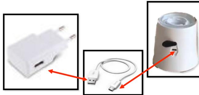
6. Während der Phase 4, sollten Sie den Akku vollständig aufladen. Heben Sie die Gummilasche an der Rückseite und schließen sie den Micro-USB-Stecker an
