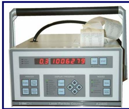
Die Firma MetOne hat sich in den letzten Jahren zu einem der weltweit führenden Anbieter von Partikelzählern entwickelt. Das angewandte Messgerät wird auch in Operationssälen, in der Forschung und Entwicklung zur Überwachung der Partikelanzahl eingesetzt (Reinraummessung).
