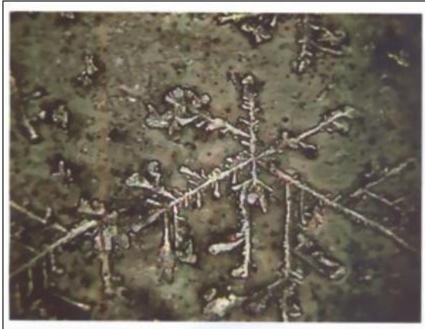
Im Vollbild zeigen sich sehr verdichtete Kristallstrukturen im Randbereich des Bildes, die auf schlecht lösliche Mineralien hindeuten, die leicht zur Ausfällung neigen. Hier ist die Verkalkungsgefahr als relativ hoch zu bezeichnen. Die verdichteten Mineralien legen sogar nahe, dass auch normale Haushaltsgeräte mit diesem Wasser ohne weitere Entkalkung kaum dauerhaft ohne Schaden betrieben werden können.
